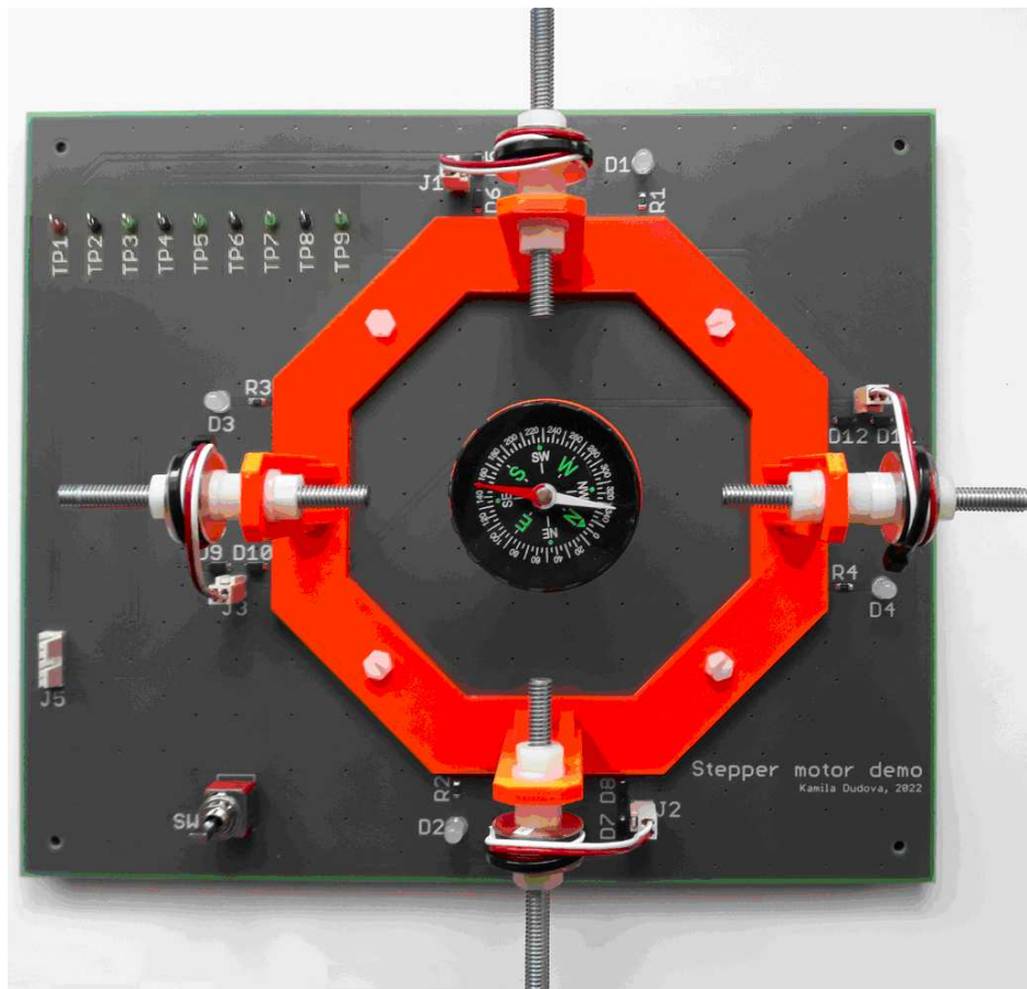
Obrázek 28 Deska DPS_STEPPER ve výsledném provedení stanoviště s cívkami a kompasem
