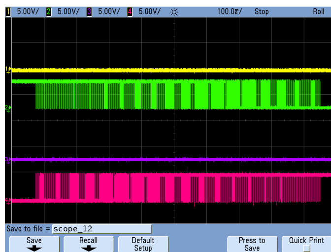
Obrázek 67 Unipolární zapojení motoru (Unipolar-TOP) - mikrokrokování (n = 10) - normální režim
