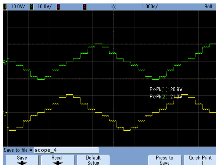
Obrázek 47 Bipolární zapojení motoru - mikrozkokování
