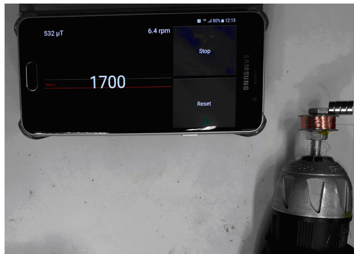
Obrázek 22 Demonstrace principu navíjení a měření počtu navinutých závitů cívek
