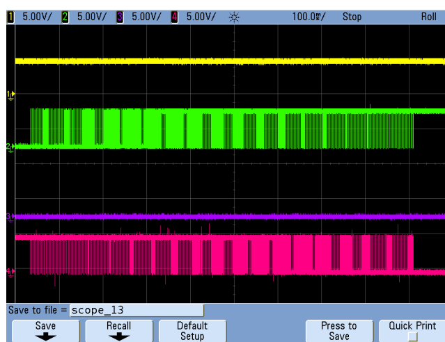
Obrázek 72 Unipolární zapojení motoru (Unipolar-BOT) - mikrokrokování (n = 10) - normální režim
