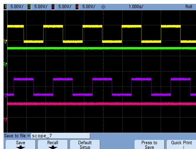
Obrázek 64 Unipolární zapojení motoru (Unipolar-TOP) - plný krok s magnetizací 2 fází
