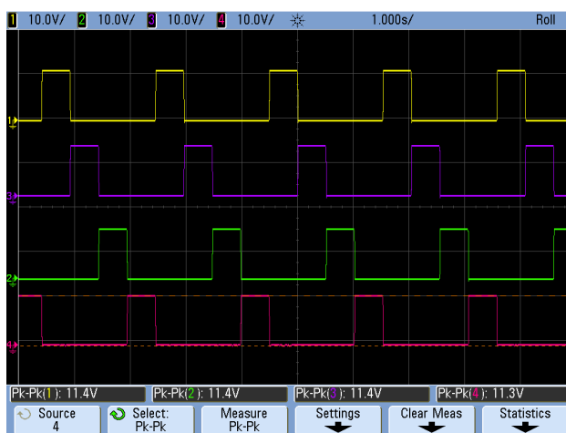
Obrázek 48 Unipolární zapojení motoru (UNIPOLAR-TOP) - plný krok s napájením 1 fáze
