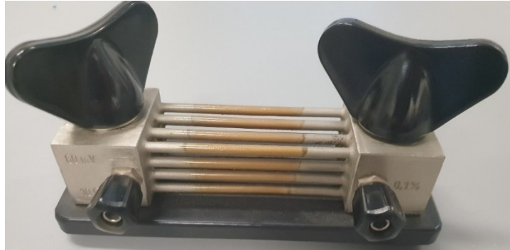
Obr. 19 Odporový bočník použitý pro laboratorním měření
