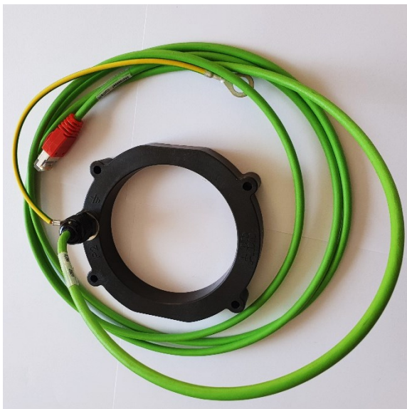
Obr. 21 Senzor proudu použitý pro laboratorním měření
