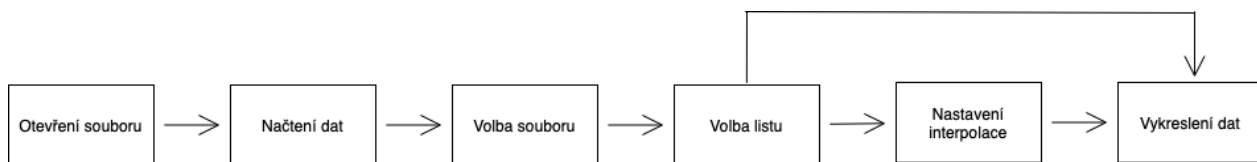
Obr. 32: Blokový diagram pro zpětné vykreslení dat [Zdroj: vlastní]
