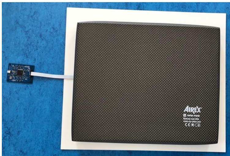
Obr. 68: Navržený senzor pro snímání pohybu na balanční podložce
