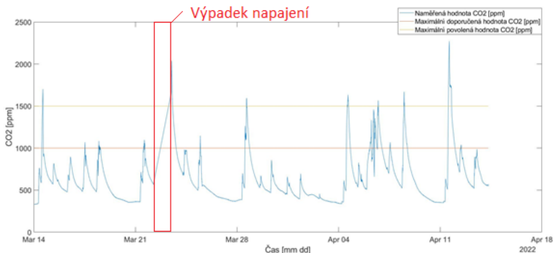
Obrázek 38. Naměřená hodnota CO 2 pomocí sondy Testo v obývacím pokoji SCH1
