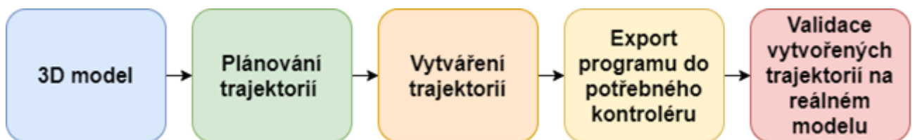
Obr. 17 Princip offline programování
