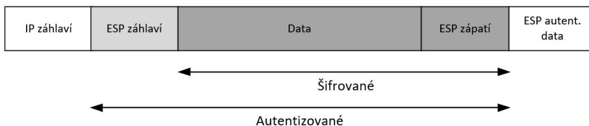
Obrázek 2.4: IPv4 paket zapouzdřen užitím ESP v transportním módu [9]
