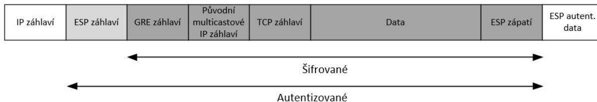
Obrázek 2.5: Struktura paketu zapouzdřeného pomocí GRE a ESP [10]
