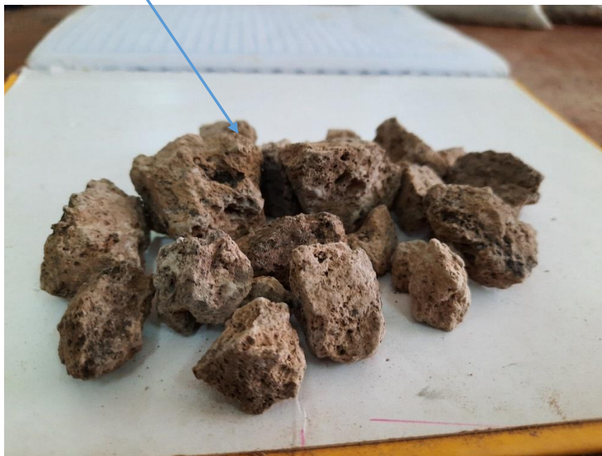
Foto 7. Material compuesto por pómez con alternancia de ceniza fina, lapilli y toba seguido de una capa de pómez con un espesor de 2m. Con coordenadas UTM 536822 E, 1366100 N. (Descrita de forma ascendente).
