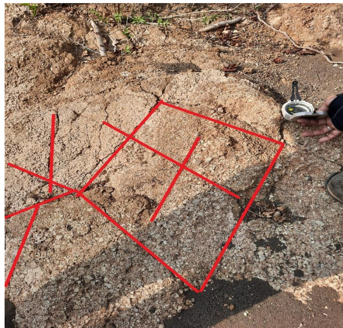
Foto 22. Fracturas conjugadas, con presencia de sigmoide, siguiendo una dirección NE-SW, con coordenadas UTM 536470E, 1370815N.
