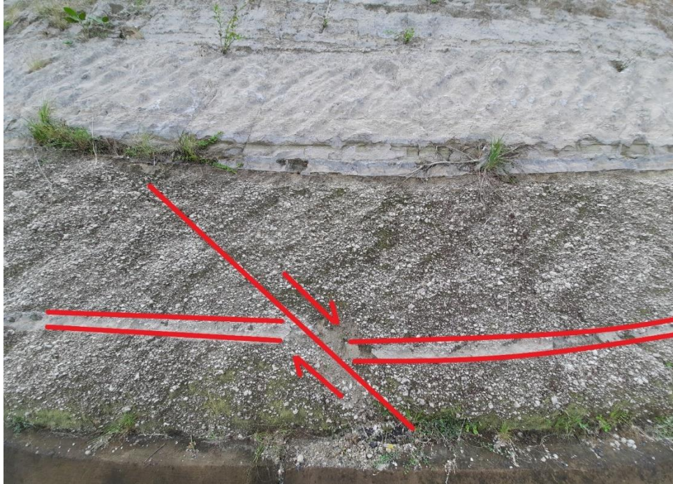
Foto 27. Falla de tipo normal con un desplazamiento de 0.22m con inclinación de 14° y dirección 48° NE. coordenadas UTM 538203 E, 13711362 N.
