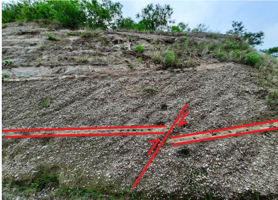
Foto 25. Falla de tipo inversa con un desplazamiento de 0.30m con inclinación de 38° y dirección 22° NE. Coordenadas UTM 538203 E, 13711362 N.
