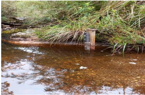
Regleta para control de caudal en la fuente
