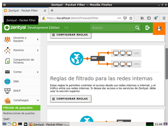
Figura 44. Reglas de filtrado para las redes internas.
