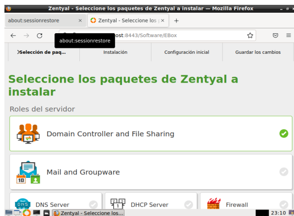
Figura 63. Instalación de paquete de Zentyal.
