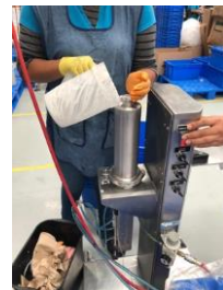
Figura 8. Purgado del pistón principal
