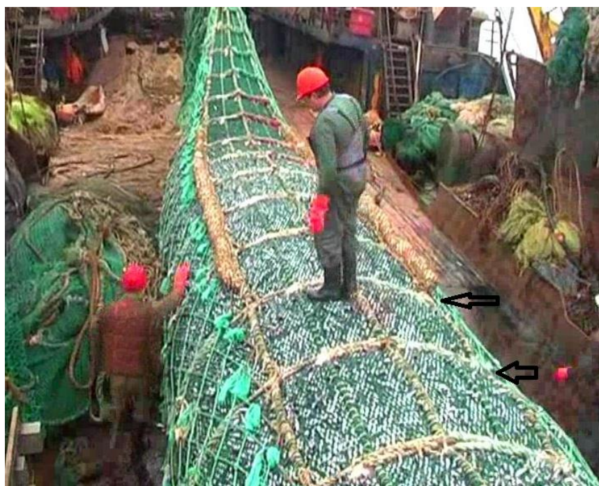
Figure 5.- le chalut de type « russe », avec des indications de distance entre deux herses.
