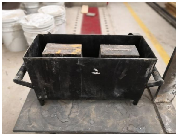
Imagen 40: Molde de acero para moldes de Block Hueco como medidas de 15x20x40 cm
