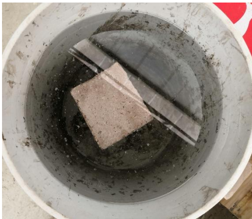
Imagen 60: Tabicón dentro de agua por 24 horas.
