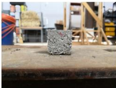
Imagen 54: Resultados de mezcla proporción 1:3:2:2:2.
