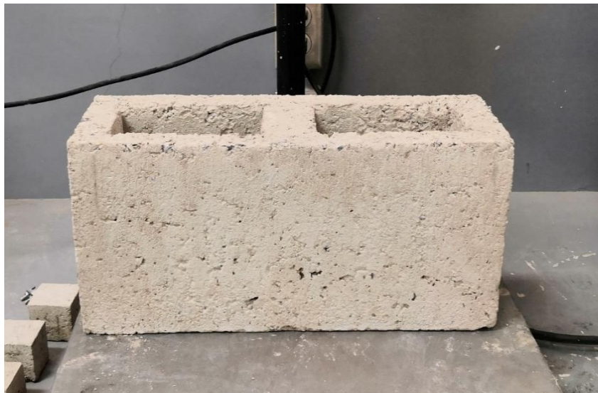
Imagen 43: Resultado mezcla 1:5:2:1.5 Cemento, Arena de Río, Gravilla Natural y Agua).
