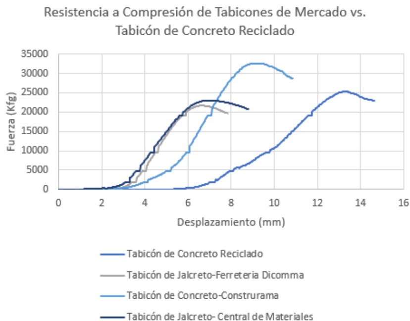
Gráfica 13: Resultado de resistencia a compresión de los tabicones.
