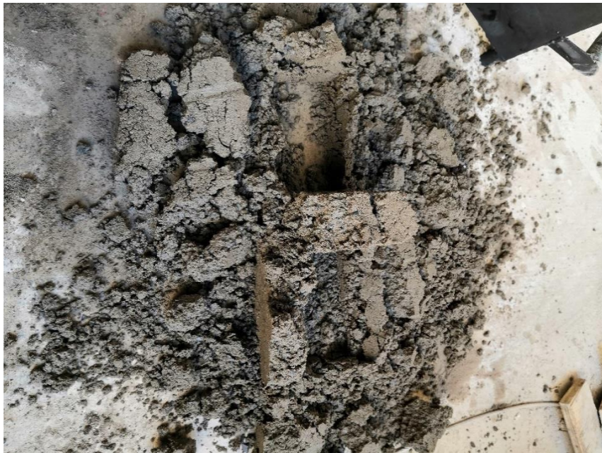
Imagen 41: Resultados mezcla 1:5:2:1 (Cemento, Arena de Río, Gravilla Natural y Agua).
