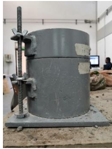
Imagen 21: Molde Cilíndrico para probeta de concreto 30cm x 20cm.
