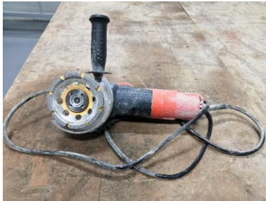
Imagen 19: Esmeriladora de 4 1/2" y Copa diamantada para desbaste de concreto 4".
