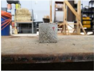
Imagen 53: Resultados de mezcla proporción 2:3:2:2:1.5.
