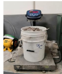
Imagen 25: Pesaje de RCD
