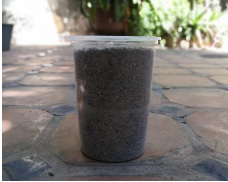
Imagen 29: Agregado Fino proveniente de la Obtención de Agregado Reciclado
