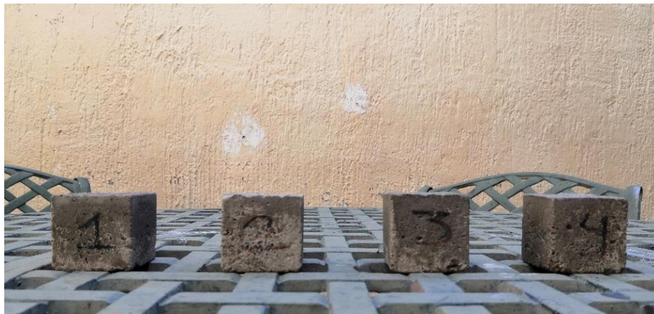
Imagen 50: Absorción en 1 hora y 30 minutos de los cubos.
