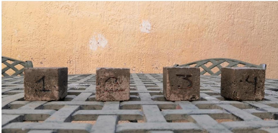
Imagen 49: Absorción en 1 hora de los cubos.
