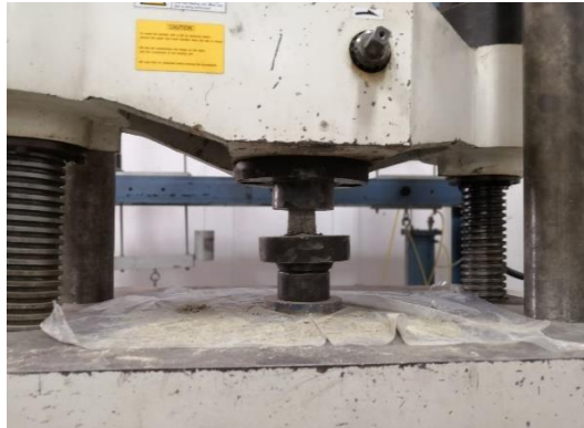
Imagen 51: Prueba de Resistencia de cubos con mezcla de concreto reciclado.
