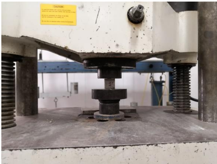
Imagen 56: Prueba de Resistencia de cubos con mezcla de concreto reciclado.
