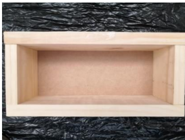
Imagen 57: Moldes de madera para tabicones con dimensiones 10 x 9 x 26 cm.
