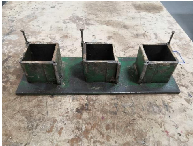
Imagen 46: Moldes de acero para cubos de 5x5x5 cm
