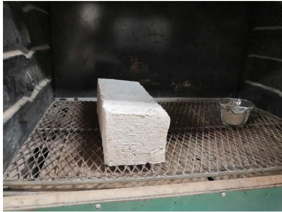
Imagen 59: Tabicón dentro del horno.
