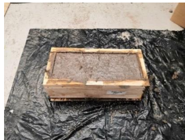
Imagen 58: Moldes de madera para tabicones con dimensiones 10 x 9 x 26 cm con mezcla.
