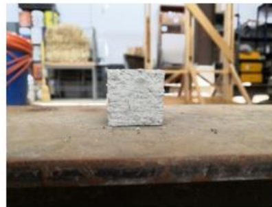
Imagen 53: Resultados de mezcla proporción 2:3:2:2:1.5.
