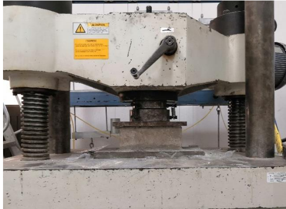
Imagen 58: Prueba de Resistencia a compresión en Tabicón.
