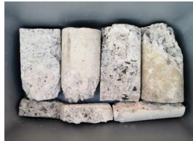
Imagen 20: RCD del Laboratorio H del ITESO colocado en una caja de 120 lts para desbaste.
