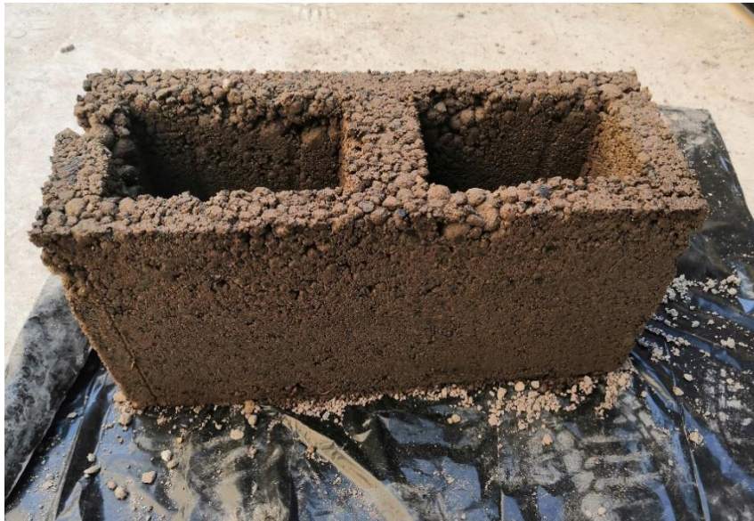
Imagen 42: Resultado mezcla 1:5:2:1.25 (Cemento, Arena de Río, Gravilla Natural y Agua).
