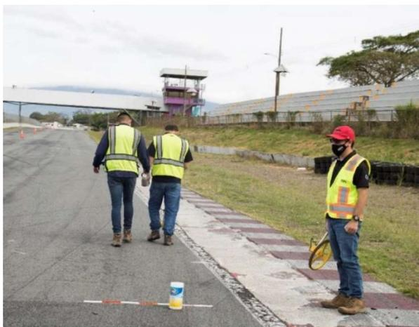
Figura 36. Se colocó cinta reflectiva en el estacionamiento inicial para garantizar que las mediciones iniciaran en el mismo punto.
