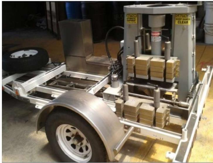
Figura 19. Deflectómetro de impacto (FWD) LanammeUCR
