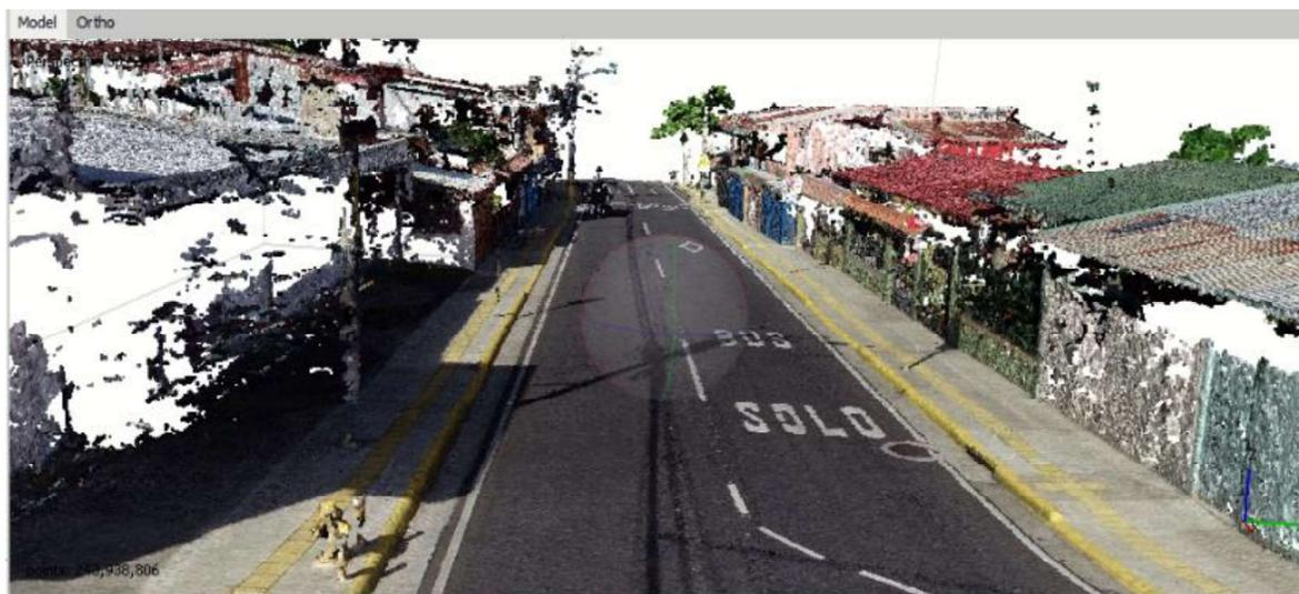
Figura 64. Nube de puntos construida a partir de las fotografías capturadas.
