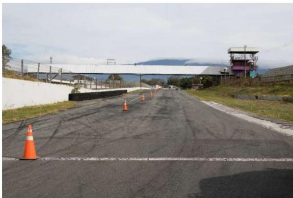
Figura 35. Se colocaron conos espaciados a cada 20 m, para delimitar un ancho de carril de 3,6 m.
