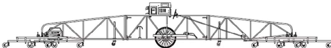
Figura 9. Perfilógrafo longitudinal tipo California
