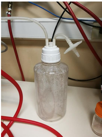
Figura 7. Sistema de venteo acoplado en la salida del sistema de fermentación en biorreactor
