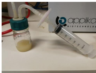
Figura 10. Sistema de toma de muestra acoplado al biorreactor
