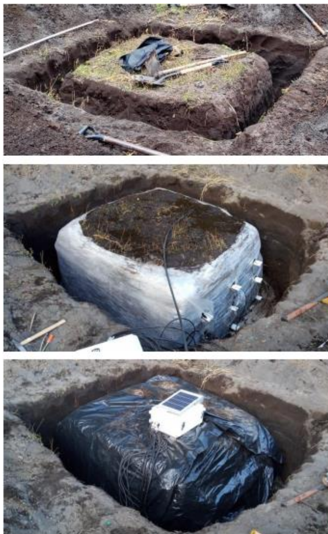
Figura 38: Proceso de construcción de los monolitos de suelo para medir experimentalmente la redistribución de agua en el perfil del suelo. Fuente: Trabajo de campo, 2019.
