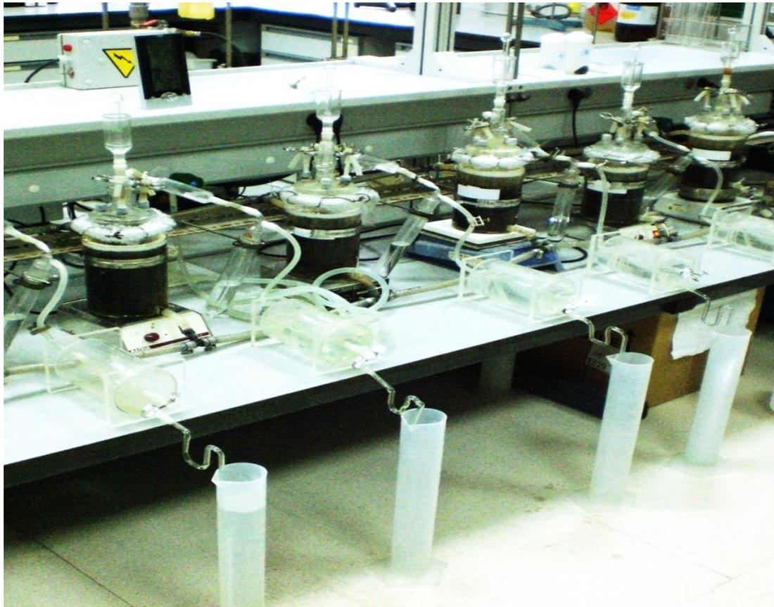
**Figure 17:** Système expérimental de digestion anaérobie (Réacteurs de 1,0L de volume utilisable) (Laboratoire UCO).
