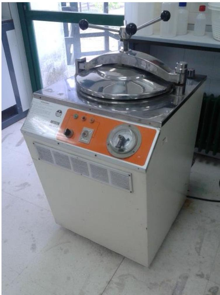
**Figure 18** : Equipement expérimental (autoclave) utilisé pour le prétraitement thermique (Laboratoire UCO).
