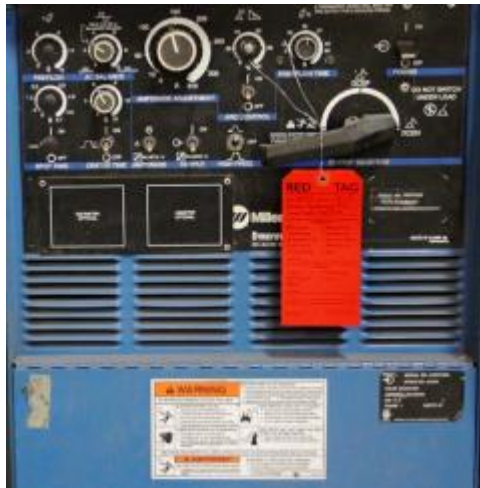
Ilustración 3.7 Ejemplo de tarjeta roja colocada en máquina. Fuente: Creativesafetysupply.com
