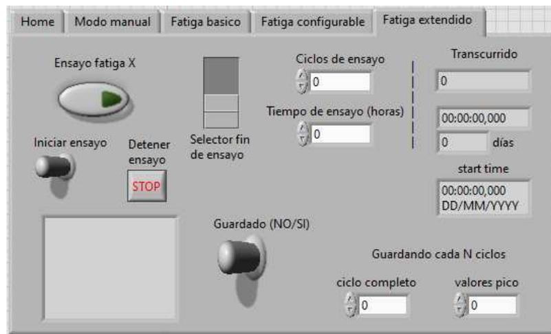
Figura 23. Pestaña «Fatiga extendido» del programa de LabVIEW
