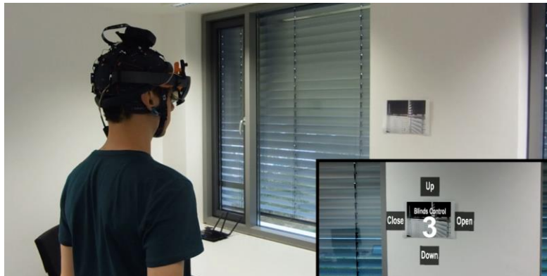
Figura 25: Control de persianas a través de la RA utilizando el paradigma SSVEP-BCI en una habitación en la que el menú permite cuatro operaciones: subir persianas, bajar persianas, cerrar persianas (aletas), abrir persianas (aletas) - las operaciones se ejecutan automáticamente a través del sistema de control inteligente del edificio
