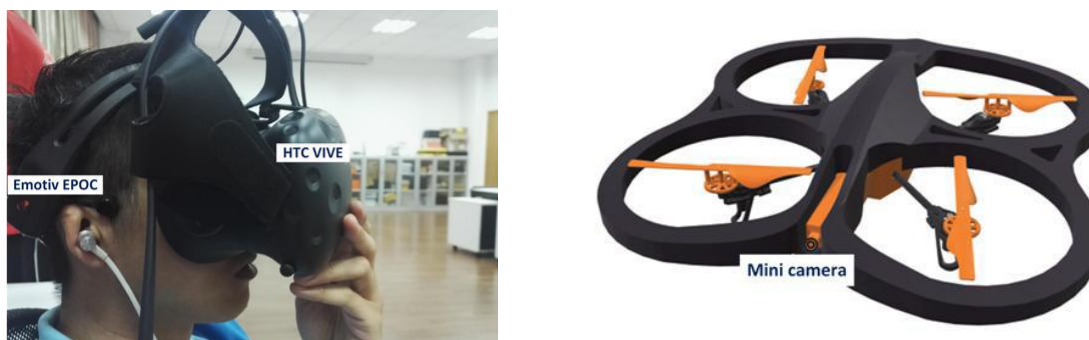
Figura 23: (a) Montaje del experimento con el casco de EEG y el HMD (b) AR Drone 2.0 con una minicámara frontal
