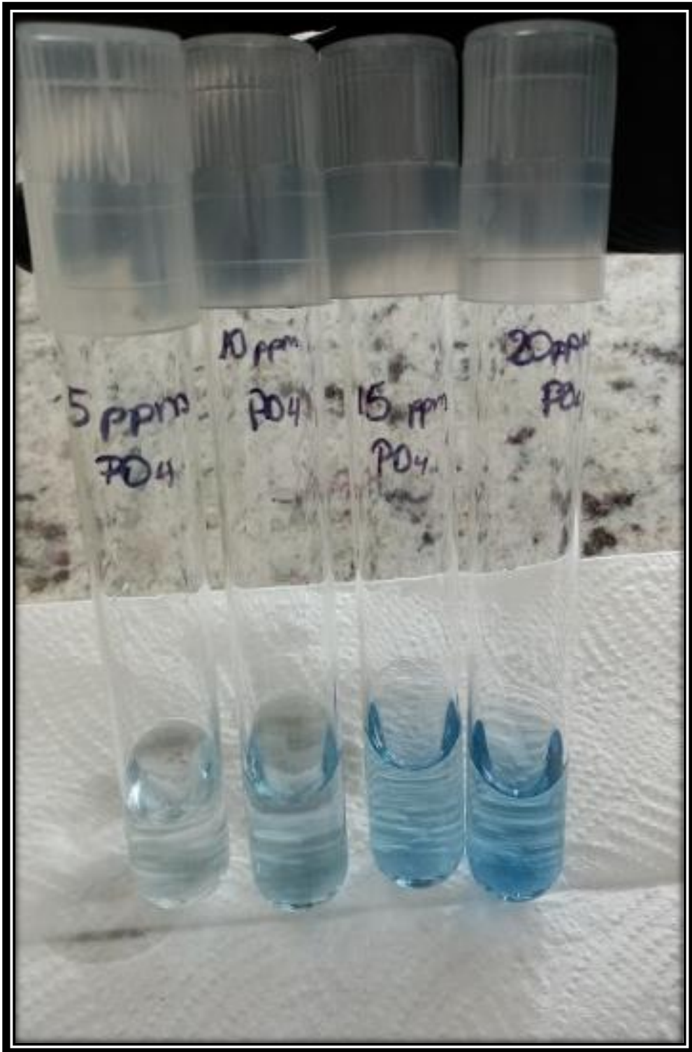
Anexo 3. Patrones para curva de calibración de fosfatos Elaborado por: (Los Autores, 2022).
