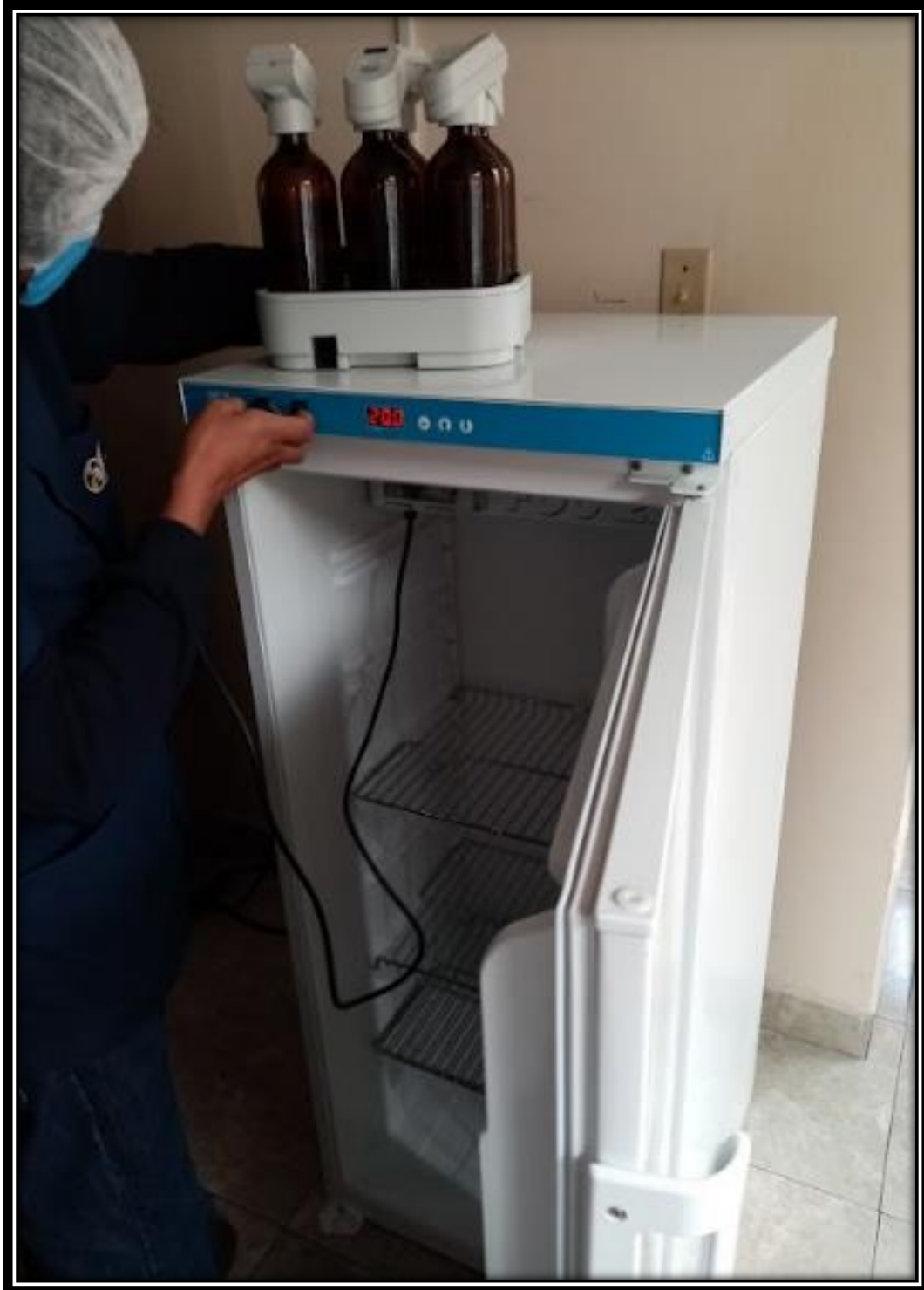
Anexo 10. Preparación de la muestra para medir DBO 5 Elaborado por: (Los Autores, 2022).
