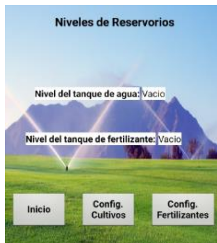
Figura.3.2-4 Pantalla de niveles de reservorios de la interfaz HMI
