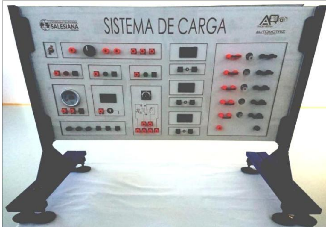
Figura 3.9 Tablero del alternador
