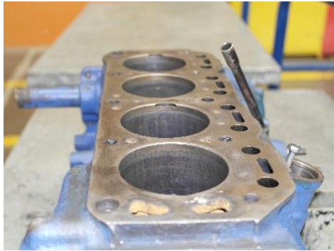
Figura 2.20 Número de cilindros motor 4 en línea ( z=4 )
