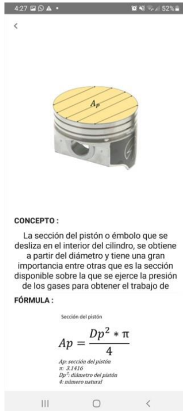
Figura 3.5 Bosquejo. Información sobre el Parámetro Geométrico “sección del pistón”
