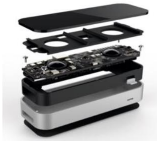
Figura 2.6. Componentes del dispositivo Leap Motion
