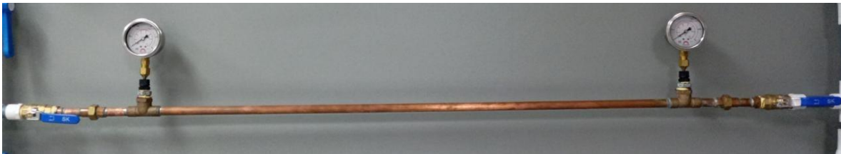
Tramo de tubería de Cobre ½”
