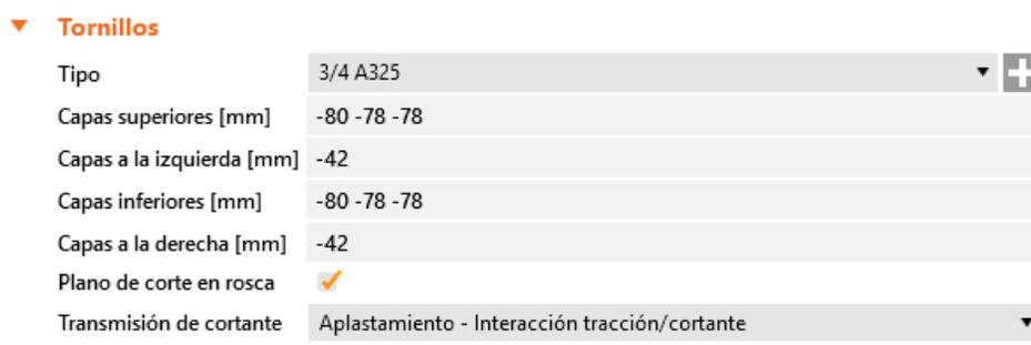
**Figura 48.** Parametrización de los pernos en conexión en el software Idea StatiCa.
