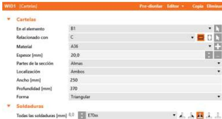
**Figura 64.** Parámetros de los rigidizadores en la conexión del software Idea StatiCa.
