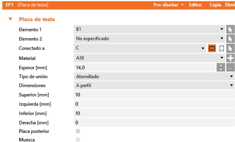
Figura 46. Parámetros del diseño para la placa atornillada en el software Idea StatiCa.
