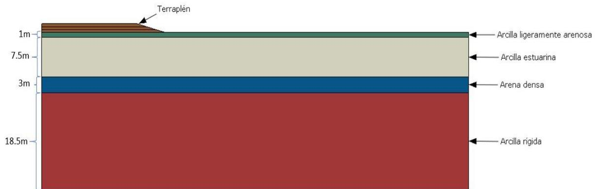
Figura 6.10: Terraplén de Teven Road modelado en Abaqus.
