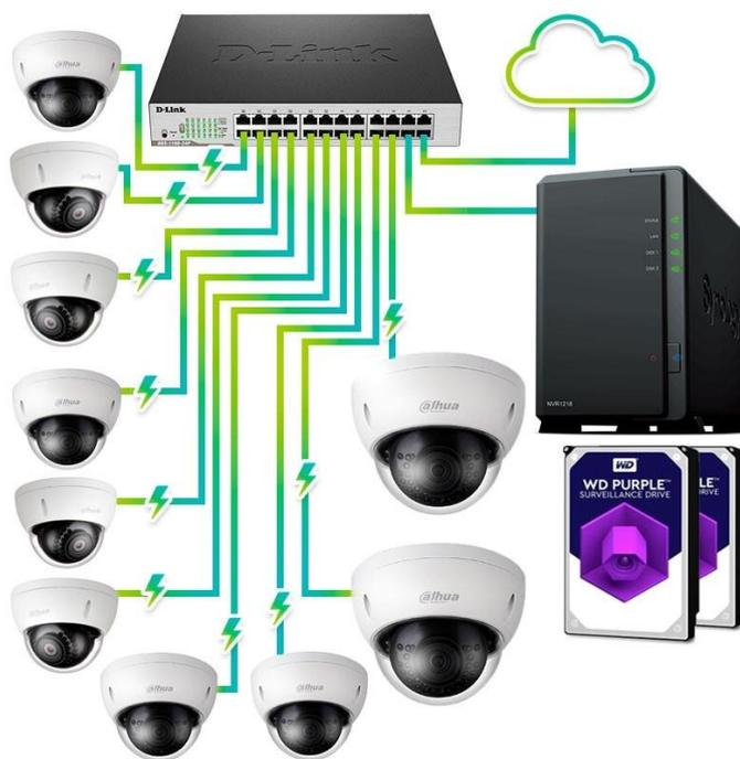
Figura 84: Video cámaras IP – Diagrama de conexión 10 videocámaras.
