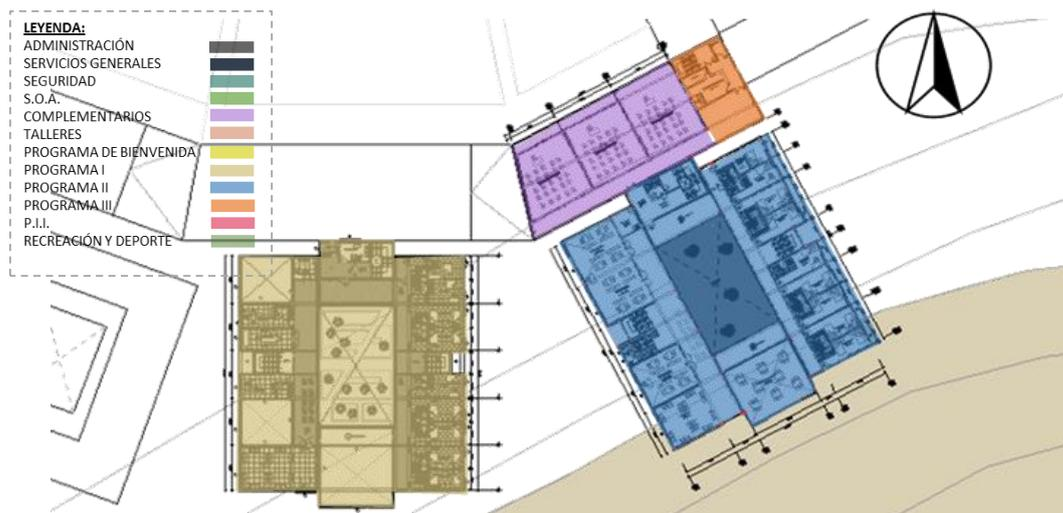
Figura 28: Esquema de zonificación en planta del proyecto arquitectónico - Nivel +9
