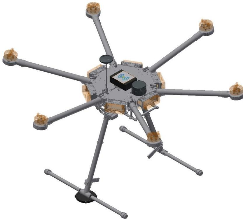
*Figura 2. 18 Vista Isométrica de la implementación del dron
