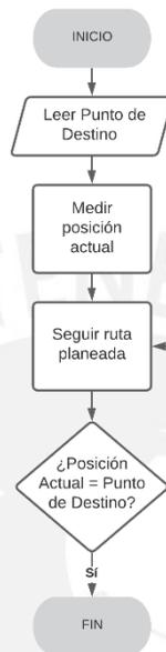
Figura 2. 49 Diagrama de Flujo de Accionamiento de Vuelo
