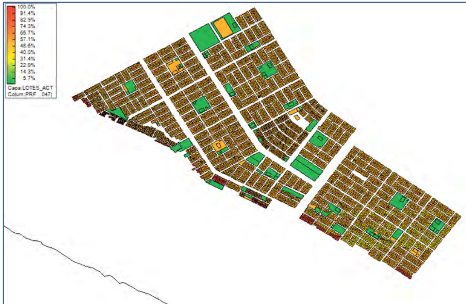
Figura 29. Daños generados en viviendas para un sismo de intensidad moderada 7.34 Mw para la zona de estudio, la leyenda muestra el porcentaje de escombros con respecto al stock de materiales (Fuente: Elaboración propia)
