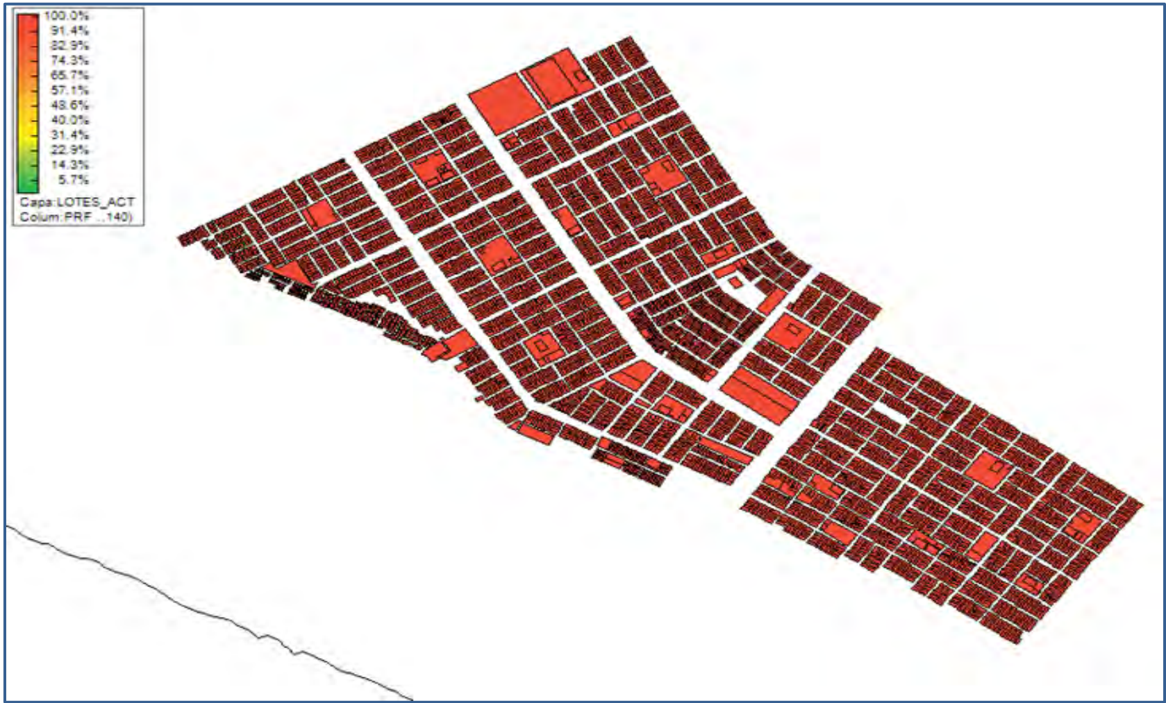
Figura 30. Daños generados en viviendas para un sismo de intensidad moderada 8.42 Mw para la zona de estudio, , la leyenda muestra el porcentaje de escombros con respecto al stock de materiales (Fuente: Elaboración propia)
