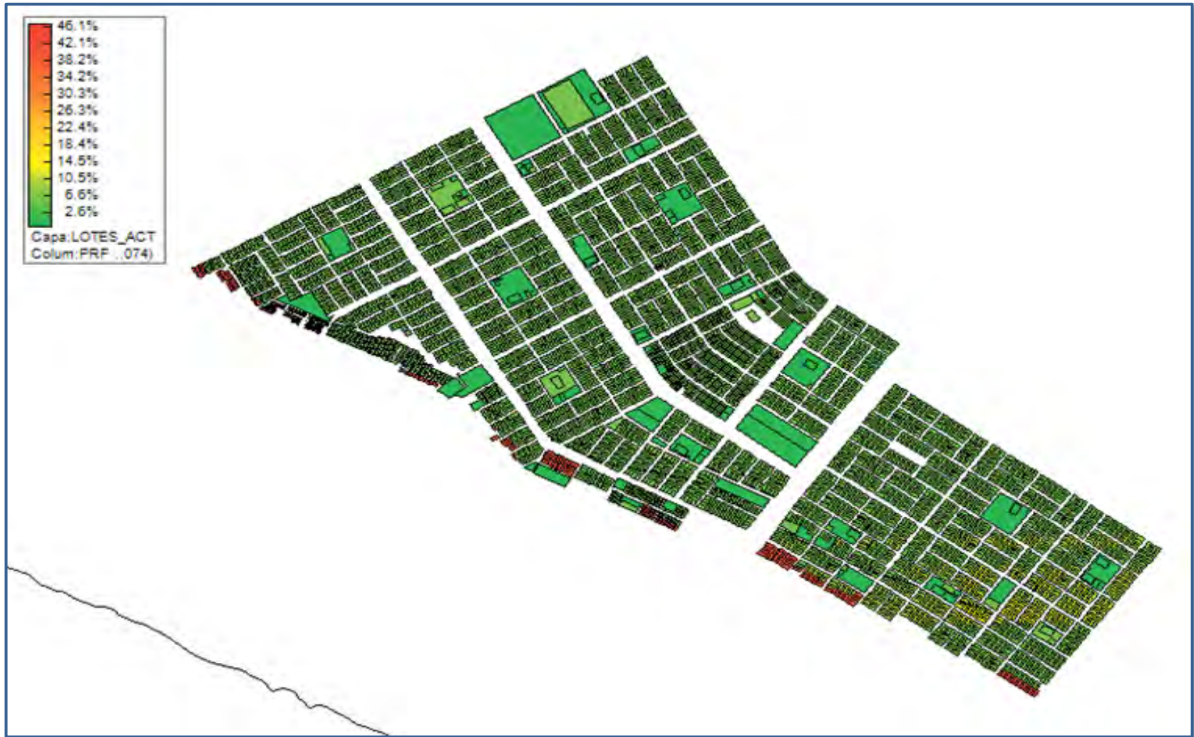
Figura 28. Daños generados en viviendas para un sismo de intensidad moderada 6.26 Mw para la zona de estudio, la leyenda muestra el porcentaje de escombros con respecto al stock de materiales (Fuente: Elaboración propia)
