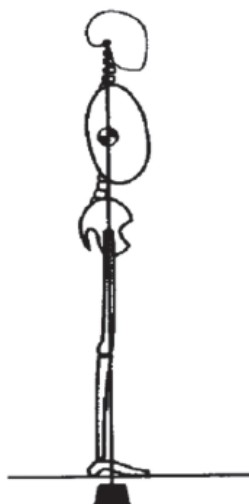
Fig. 1.3: Proyección de la vertical sobre la tierra que atraviesa al BOS y COM. [Luengas, 2013]
