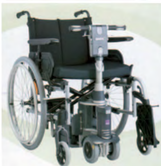
Fig. 2.5: Silla manual motorizada y controlada a través de un manillar. [Guillon, 2009]
