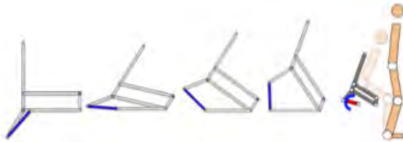
Fig. 2.20: Funcionamiento del mecanismo de ayuda para la posición bípeda. [Jiang, 2019]
