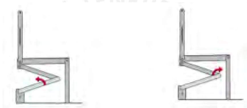
Fig. 2.16: Movimiento entre links del sistema de posicionamiento vertical. [Goher, 2013]
