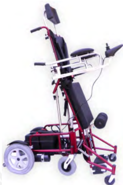
Fig. 2.7: Modelo de SRE con sistema bípedo y soporte acolchado para rodillas 3
