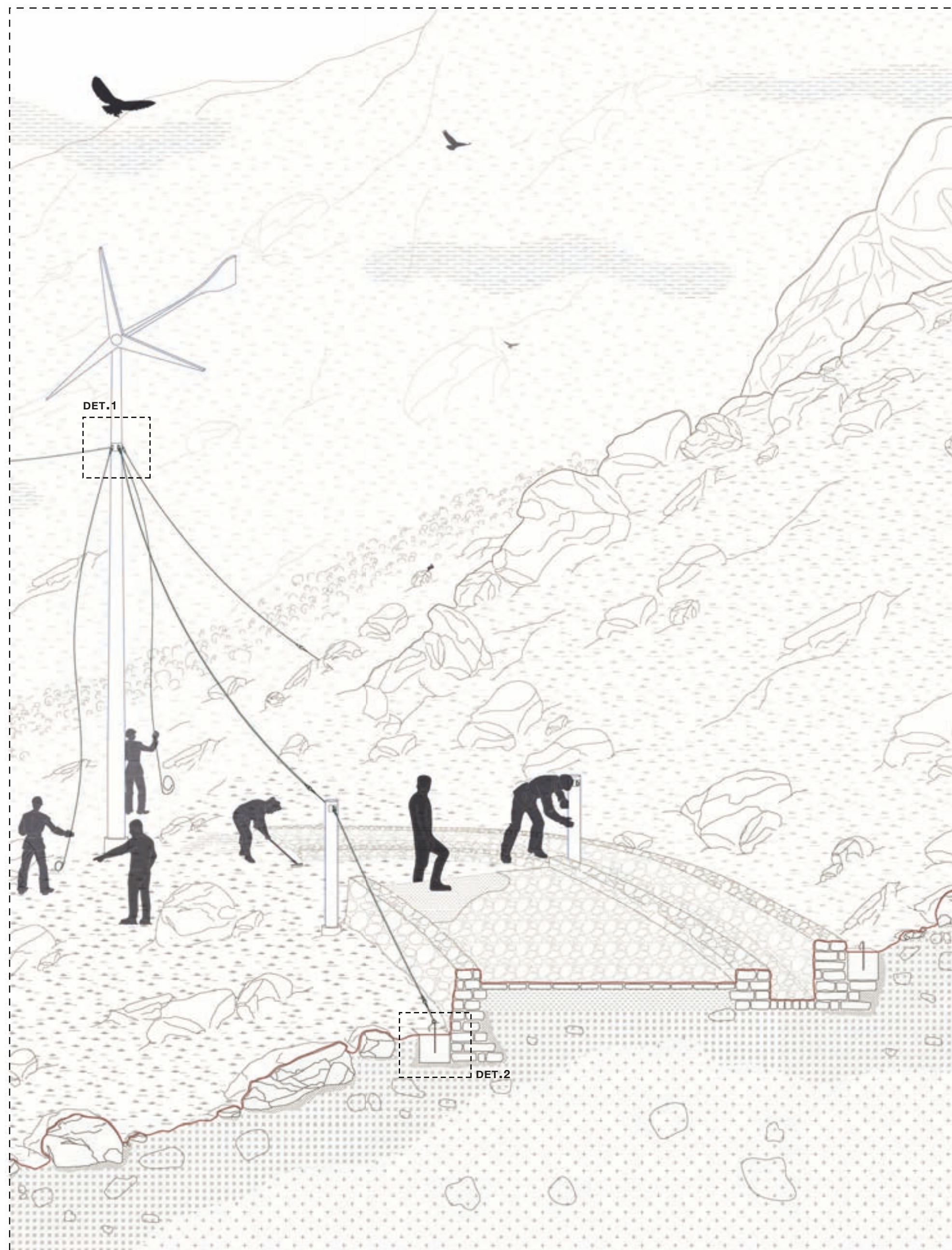
1 CAMINO ENROCADO, POSTES ESTRUCTURALES Y ANCLAJES
