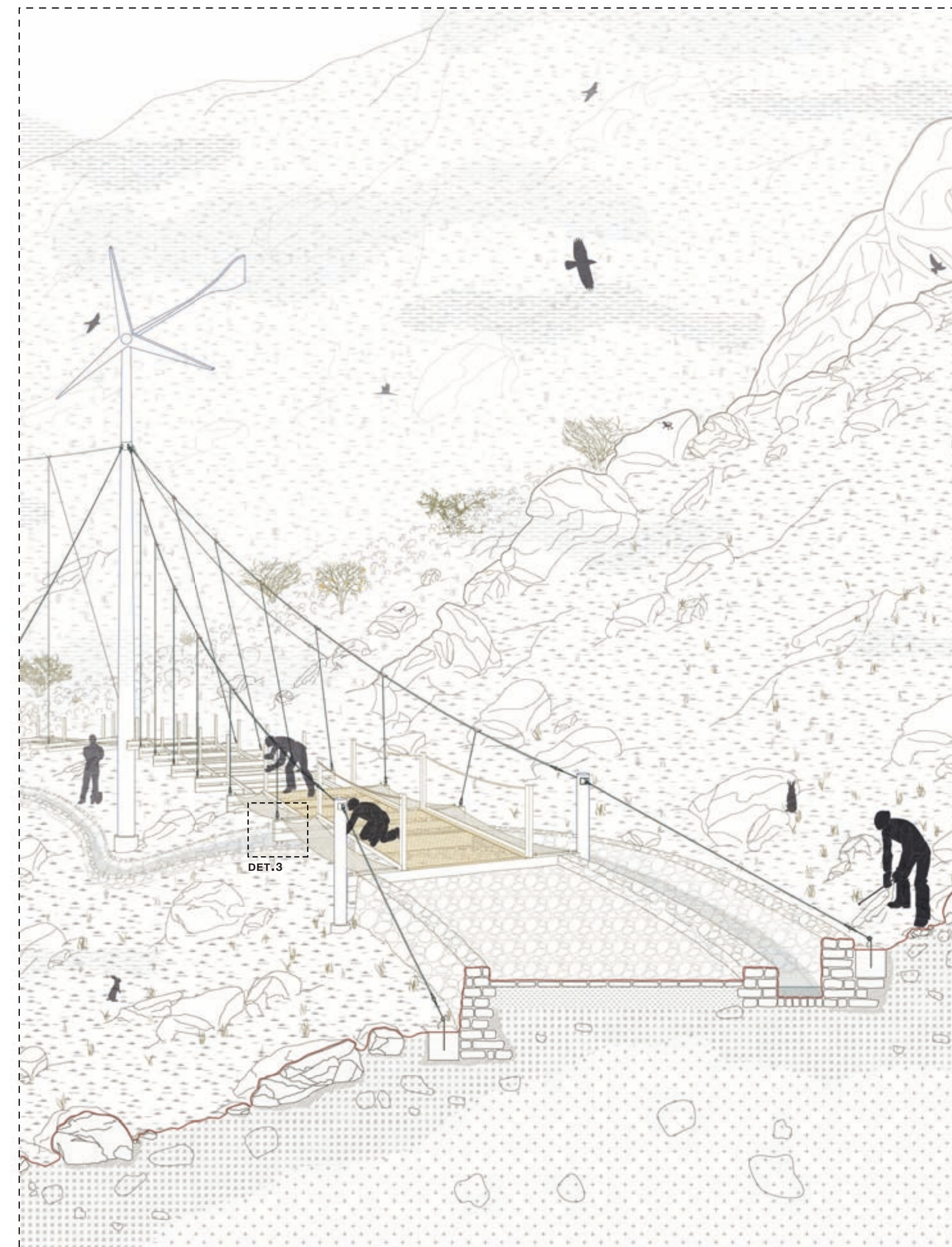
2 PÉNDOLAS, TRAVIESAS, VIGUETAS Y TABLERO
