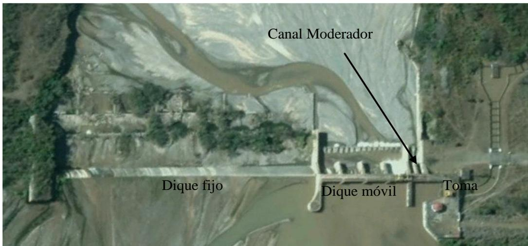
**Figura3.-** Zona de estudio con extensiones de la zona modelada numéricamente y con modelo físico en la UNC.
