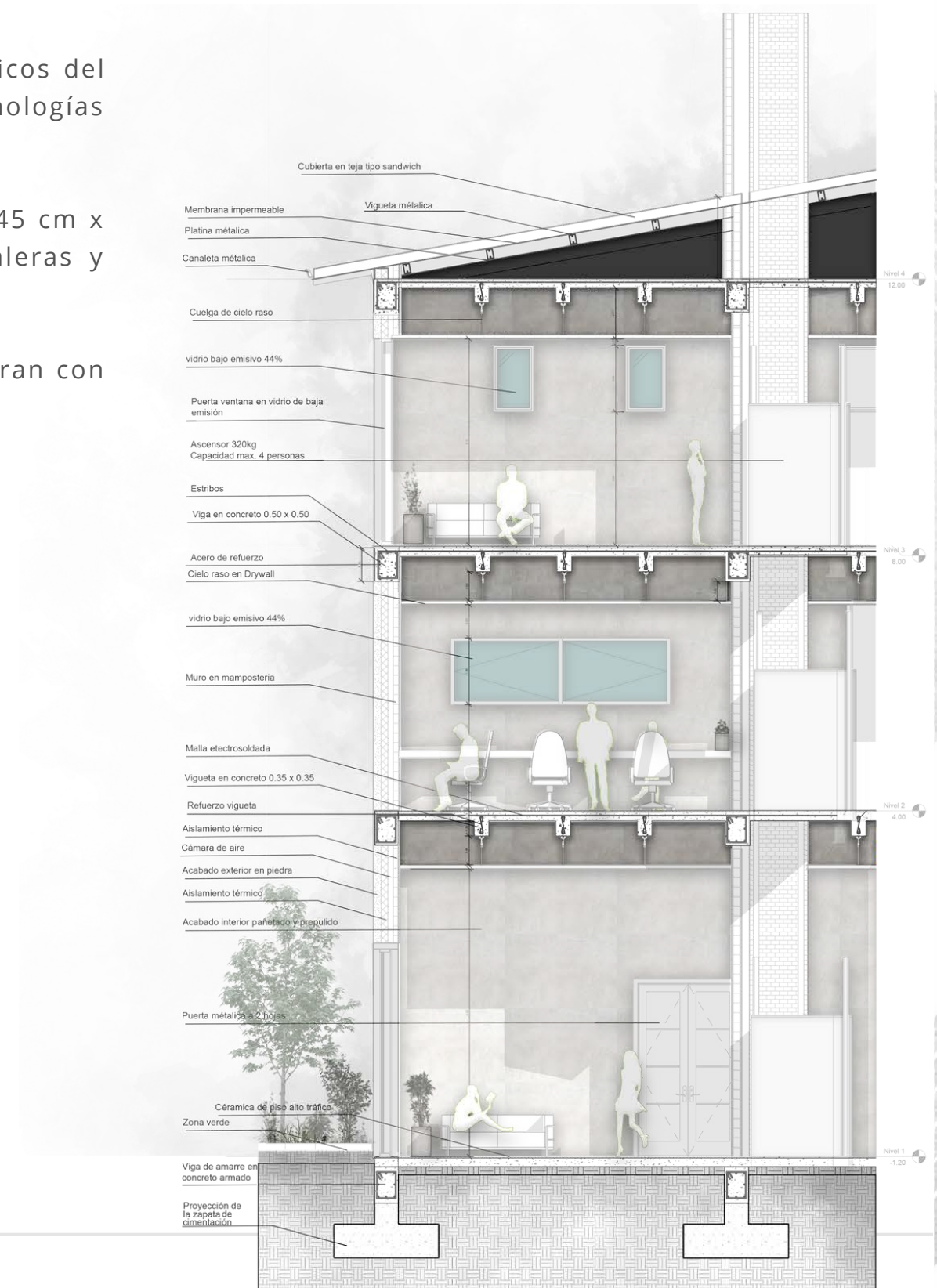
Fig. 61: Corte por fachada. Fuente: Moreira, 2022.
