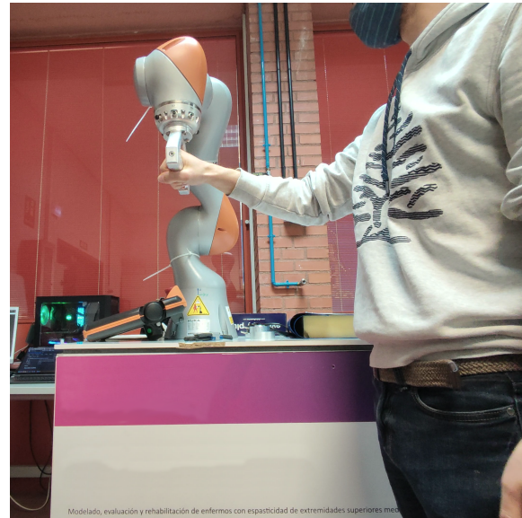
Figura 1: Robot IIWA con maneta para rehabilitación
