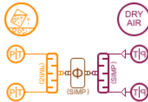
Imagen 4-21: Componentes para modelar un intercambiador de calor en AMESIM
