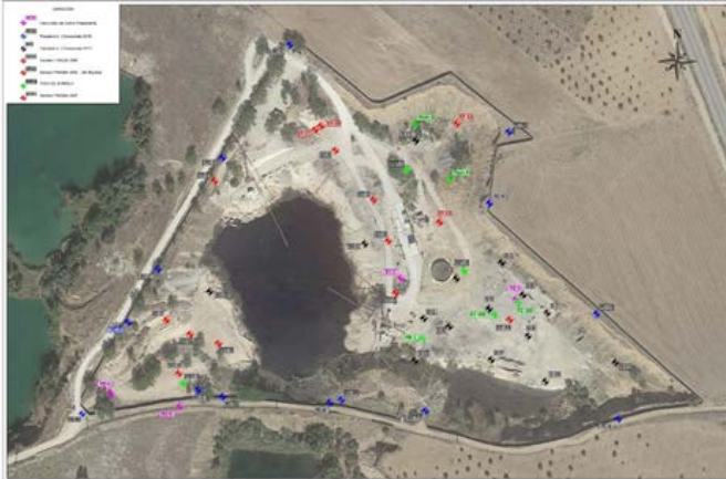
Figura 11. Sondeos de investigación y control realizados en la parcela. Figure 11. Research and control drillings constructed on the plot.
