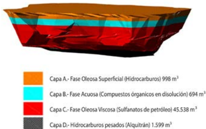
Figura 5. Vista en 3D de las cuatro capas identificadas en la laguna principal y cubicación de los residuos presentes en cada capa. (TRAGSA and EMGRISA, 2013).
