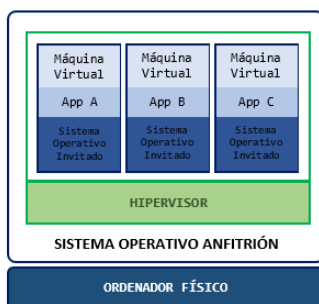
Figura 3.14: Arquitectura Máquinas Virtuales.
