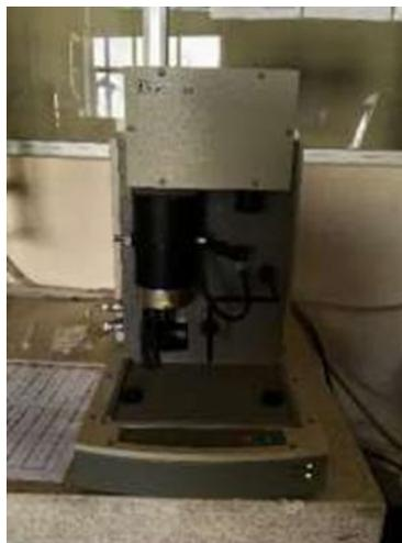
**Figura 18:** Termobalanza TGA 2050.
