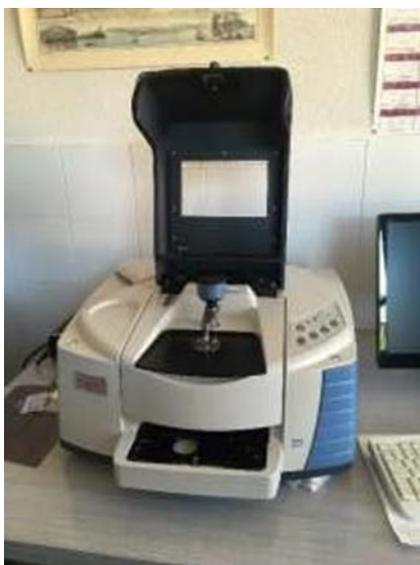
**Figura 16:** Espectrofotómetro infrarrojo Nicolet iS10.
