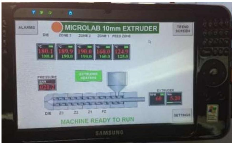
*Figura 14: Perfil de temperaturas de la extrusora.*
