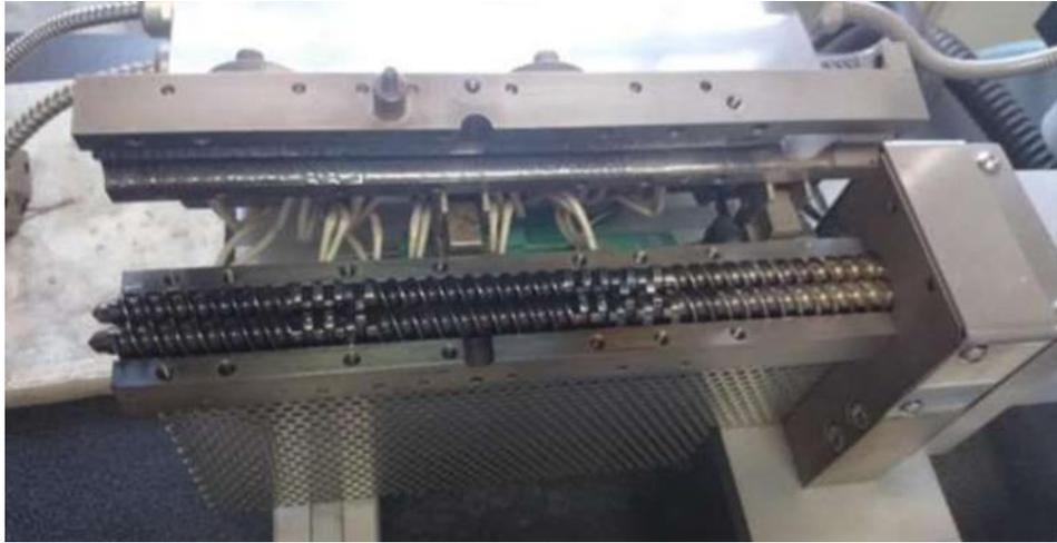
**Figura 11:** Extrusora de doble husillo abierta. Disposición de los husillos.
