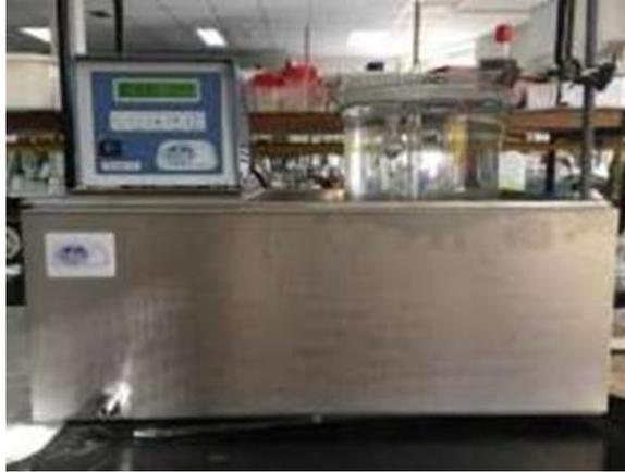
**Figura 19:** Montaje para la determinación de la viscosidad intrínseca del PLA.
