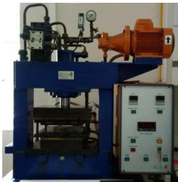
*Figura 15: Prensa hidráulica de platos calientes.*
