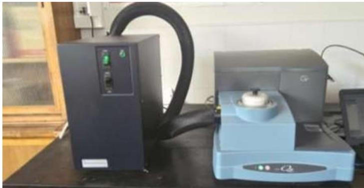
**Figura 17:** Calorímetro TA Q-20.
