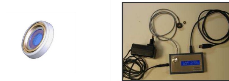
Figura 4.8: Imagen de la lente varifocal utilizada y del dispositivo para su control.
