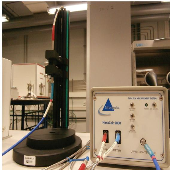
Figura 2.11: Equipo de medida NanoCalc, configuración para la medida de transmitancia.
