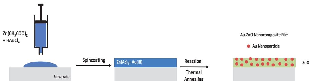
Figura 3.1: Esquema de preparación de las capas de *Au – ZnO*
