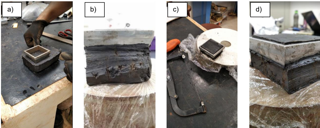
Figura 28 – Processo do solo talhado e inserido no molde biselado. a) Amostra talhada inserida ao molde biselado. b) Deslizamento do solo sobre o molde biselado. c) e d) Detalhes do processo concluído
