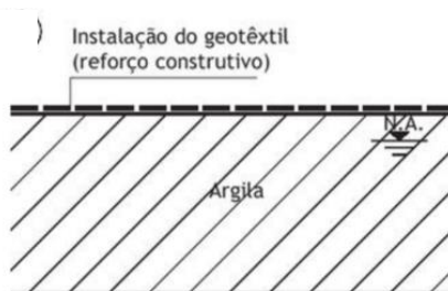
Figura 4. Reforço de aterro com geotêxtil
