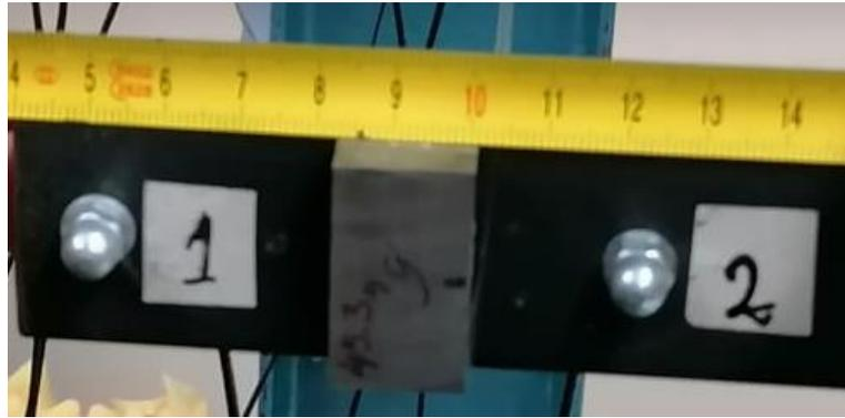
*Figura 4.15 - Introdução do dano na viga experimental*
