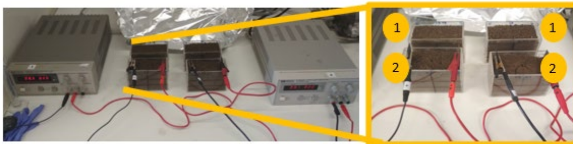
Figura 3.3 - Configuração da experiência (controle (1) e aplicação de corrente (2))
