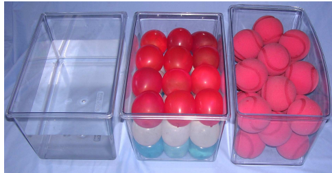
Fig.5 – Dal fluidi ideale al modello a palloncini pieni d'acqua a quello a palle di gommapiuma per comprendere la trasmissione della pressione nei liquidi
