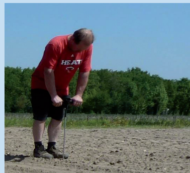
Rivignano. Prova con penetrometro su terreno lavorato
