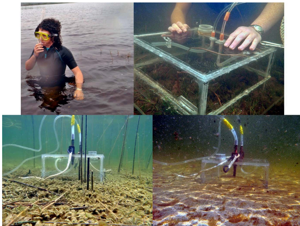
Figure 2 : En haut : Mise en place des chambres benthiques : l'installation se fait en apnée (juin 2013). En bas : Chambre benthique en cours d'utilisation sur substrat végétalisé (à gauche) et sur sol nu (à droite). Les isoétides sont souvent recouvertes par une couche épaisse de biofilm, qui abrite des micro-algues, des bactéries, des champignons, des micro-invertébrés. Le sol nu, constitué essentiellement par du sable, est souvent recouvert par une couche de micro-algues. Photos : Gwilherm Jan, Cristina Ribauda
