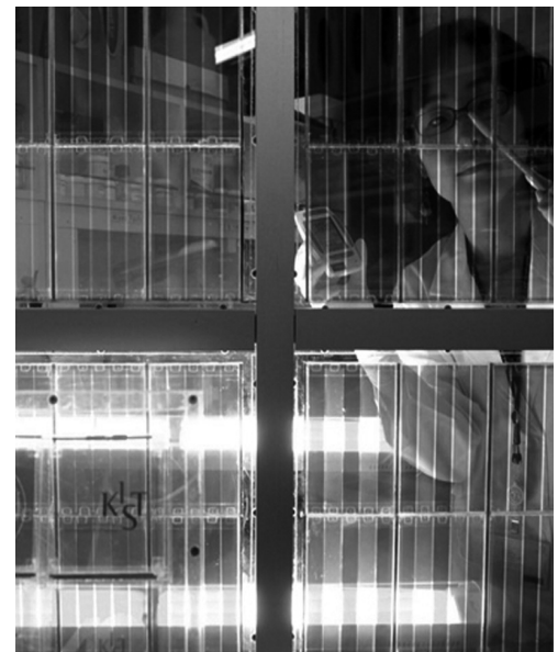
Fig. 27 - Film fotovoltaici applicati su vetro.
