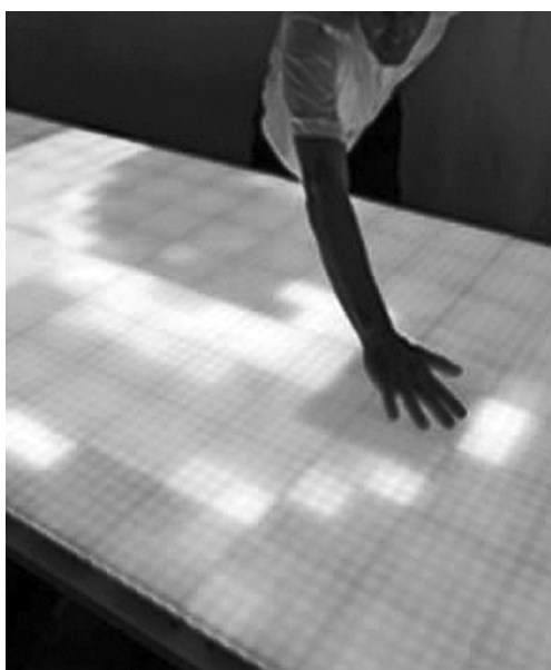
Fig. 9, 10 - Superfici in materiali compositi a base di polimeri sintetici, rinforzati con fibre di vetro, che cambiano colore al variare di temperatura e di condizioni meccaniche.
