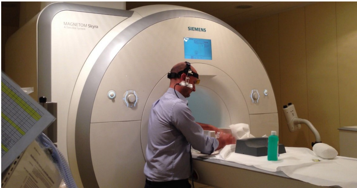
Figura 2 | Misura, con la sonda Metrolab THM1176, dell'induzione magnetica percepita come variabile dal soggetto in movimento durante la simulazione di un'azione realistica.
